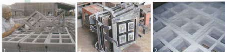
1・3: ホテルリゾネックスのためにつくられた菱形ブロックを組み合わせる、山内ブロックの安里さん。(1は撮影: 本誌編集部) / 2: ブロック製造の金型枠。
